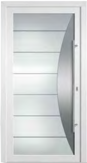
BL1800 Ansicht A / DIN rechts 3 Ganzglasfüllung 3-fach Glas Ug 1,1 bei 36 mm, dunkle Streifen Klarglas, helle Flächen mattiert, bogenförmige Applikation in Edeldstahloptik auf ESG ■ Griff 3721200, 1200 mm
