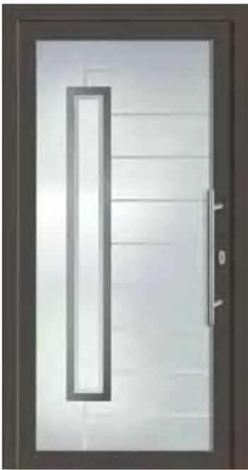
BL1802 Ansicht A / DIN rechts 3 Ganzglasfüllung 3-fach Glas Ug 1,1 bei 36 mm, helle Flächen mattiert, dunkle Streifen Klarglas, rechteckige Rahmenapplikation in Edeldstahloptik ■ Eisenglimmer ■ Griff 3720600, 600 mm
